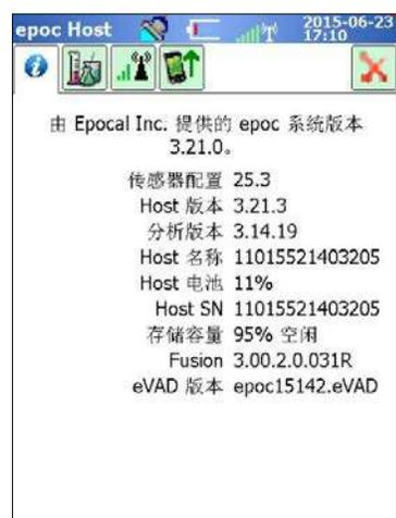
选项卡 1 提供 Host 的基本硬件和软件信息，包括传感器配置和当前安装在 Host 上的 Host 软件版本。
