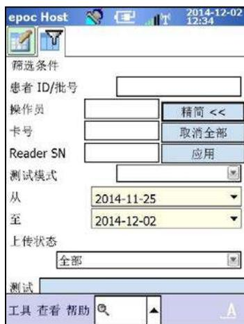
可使用 **过滤** 界面缩小测试结果
