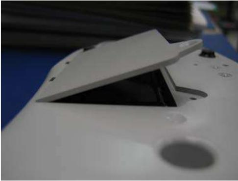
7) 将电池盖折叶以约 30° 倾角插入电池后方，从而装上电池盖。需要对电池盖边缘施力，从而让折叶卡入到位。从而关上电池盖。
