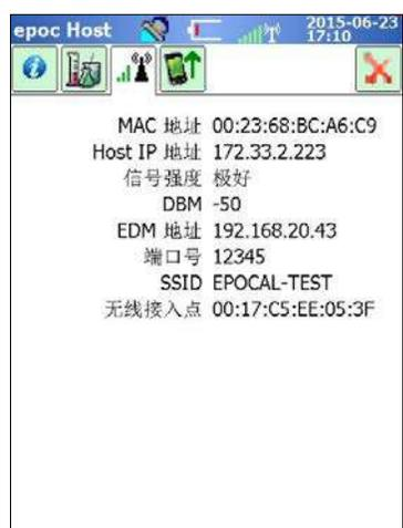
选项卡 3 包含了建立 Wi-Fi 和蓝牙连接的必要信息，包括 Host 和 EDM 的 IP 地址。
