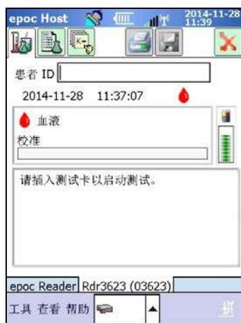
用户可使用手写笔点触软件中的**选项卡**导航到应用程序的不同部分，并通过**按钮**进行操作和开启文本框进行输入。
