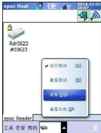
点触屏幕底部的 **工具栏** 按钮
