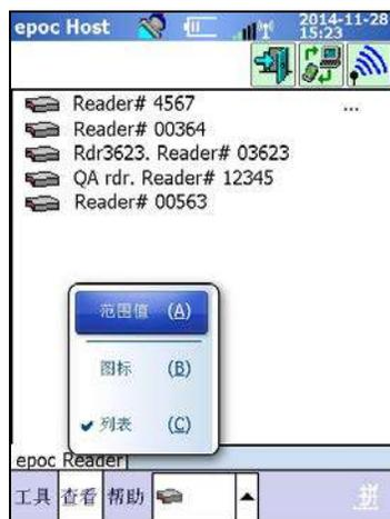
专用 Reader 始终列出，并以**锁定**图标表示：
