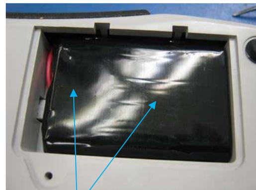
确保电池上方无电线
