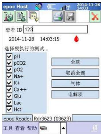
从 Reader 屏幕上选择
