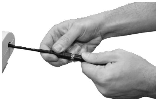
Figure 3-2. Branchement du câble d'alimentation de sortie du bloc d'alimentation au câble d'entrée de la centrifugeuse
