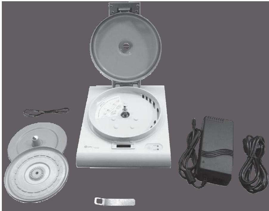
Figure 3-1. Centrifugeuse capillaire QBC avec les pièces et accessoires.
