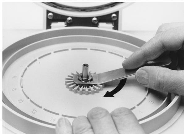
Figure 3-5. Serrage du Rotor avec clé à écrou à tête
