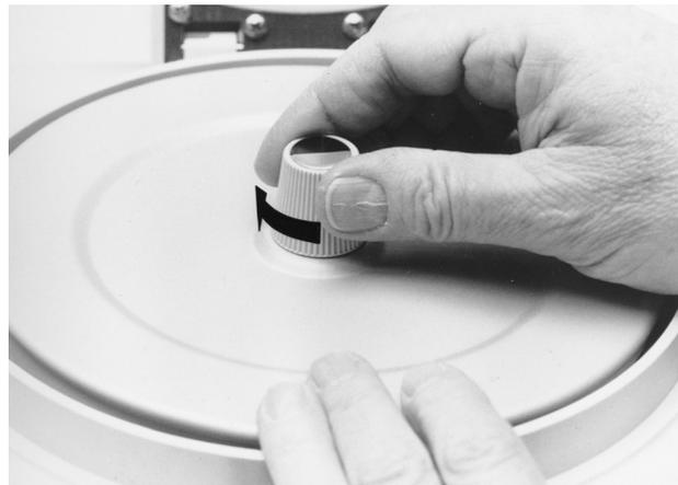
Figure 4-4. Serrage du bouton du couvercle du rotor.
