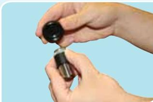
Dévisser l'ensemble de corps principal du couvercle du boîtier protecteur en maintenant l'ensemble et en tournant le couvercle dans la direction indiquée.
