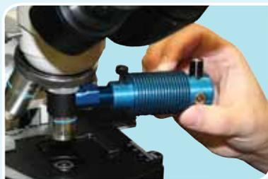
◀ Serrer la vis à oreilles jusqu'à ce que la source de lumière soit rigide fixée.
