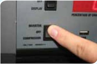
**3.** Placer le commutateur inverseur/compresseur sur la position "INVERTER". Vous êtes maintenant prêt à alimenter votre source de lumière à LED ParaLens Advance.
