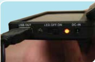
6. Placer l'interrupteur sur la position de marche "ON". Si la lumière solaire est insuffisante, le voyant indicateur clignote en rouge.
