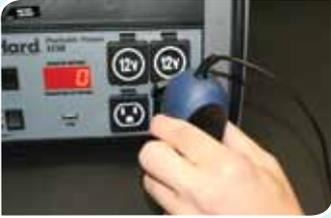
**2.** En utilisant un adaptateur d'alimentation de type U.S. et le bloc d'alimentation, raccorder la source de lumière ParaLens à la prise d'alimentation C.A. portable.
