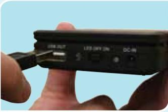
2. Raccorder le cordon d'alimentation USB dans le port "USB-OUT".
