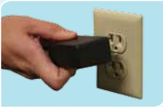
3. Verbinden Sie das externe Netzladegerät mit einer 120 V Wechselstromquelle, z. B. einer US-Steckdose. (Wenn die Batterie den vollen Ladestand erreicht, wird sie nicht überladen. Die vollständige Ladung kann bis zu 48 Stunden dauern.)
