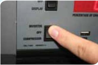
**3.** Stellen Sie den Wechselrichter/Kompressor-Schalter auf „INVERTER“ (Wechselrichter). Nun kann die LED-Lichtquelle des ParaLens Advance eingeschaltet werden.
