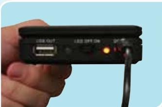
**3.** Stecken Sie das Gleichstromnetzteil in den Anschluss mit der Aufschrift „DC-IN“ (Gleichstromeingang) mit der Solarstromversorgung, um den Lithiumionenakku vollständig zu laden. Ein rotes Licht zeigt einen Ladestatus von <50 %, ein orangefarbenes Licht zeigt einen Ladestatus von >50 % und ein grünes Licht zeigt eine volle Ladung.
