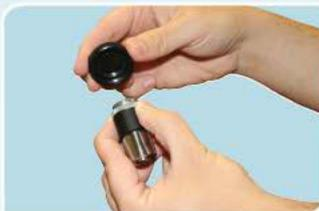
Rimuovere l'unità principale dalla parte superiore dell'alloggiamento svitando la parte superiore nella direzione indicata e tenendo saldamente l'unità.
