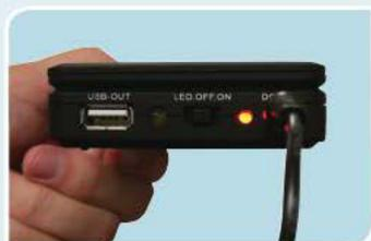
3. Collegare l'adattatore a muro CC ad una presa a muro e caricare completamente la batteria agli Ioni di Litio. La spia rossa indica un livello di carica <50%, la spia arancione indica un livello di carica >50% e la spia verde indica un livello di carica del 100%.
