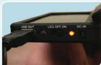
6. Premere l'interruttore di alimentazione in posizione "ON". Se la luce solare non è sufficiente, la spia rossa lampeggia.
