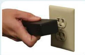
3. Collegare la spina del caricabatterie esterno a una presa da 120 V CA (es. presa a muro statunitense). (Durante il caricamento, la batteria non supera mai il 100% di carica. Il caricamento completo può richiedere fino a 48 ore.)
