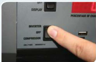
3. Spostare l'interruttore invertitore/compressore in posizione "INVERTER". Ora è possibile utilizzare la sorgente luminosa a LED di ParaLens Advance.
