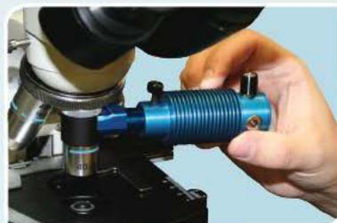
◀ Serrare la vite ad alette fino a fissare saldamente la sorgente luminosa.
