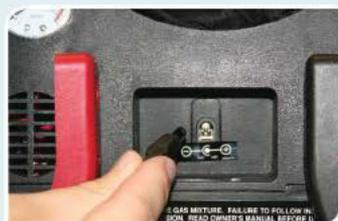
2. Inserire la spina dell'adattatore di potenza in ingresso sul retro del kit di alimentazione.
